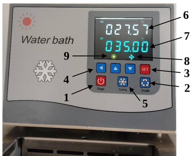
Rys.2. Panel sterujący i wyświetlacz ultratermostatu.
