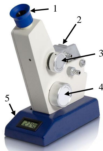
Rys.1. Refraktometr Abbego: 1 – okular ze skalą; 2 – pryzmat górny oświetlający, 3 – pokrętło korekcji dyspersji, 4 – pokrętło nastawcze, 5 – termometr.
