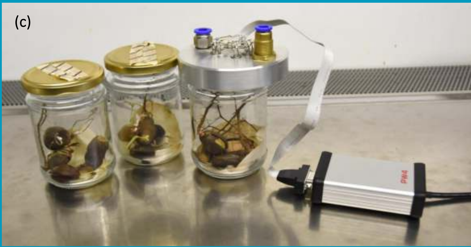
c) e-nos PW4 własnej konstrukcji podczas pomiaru zarażonych żołądździ dębu
