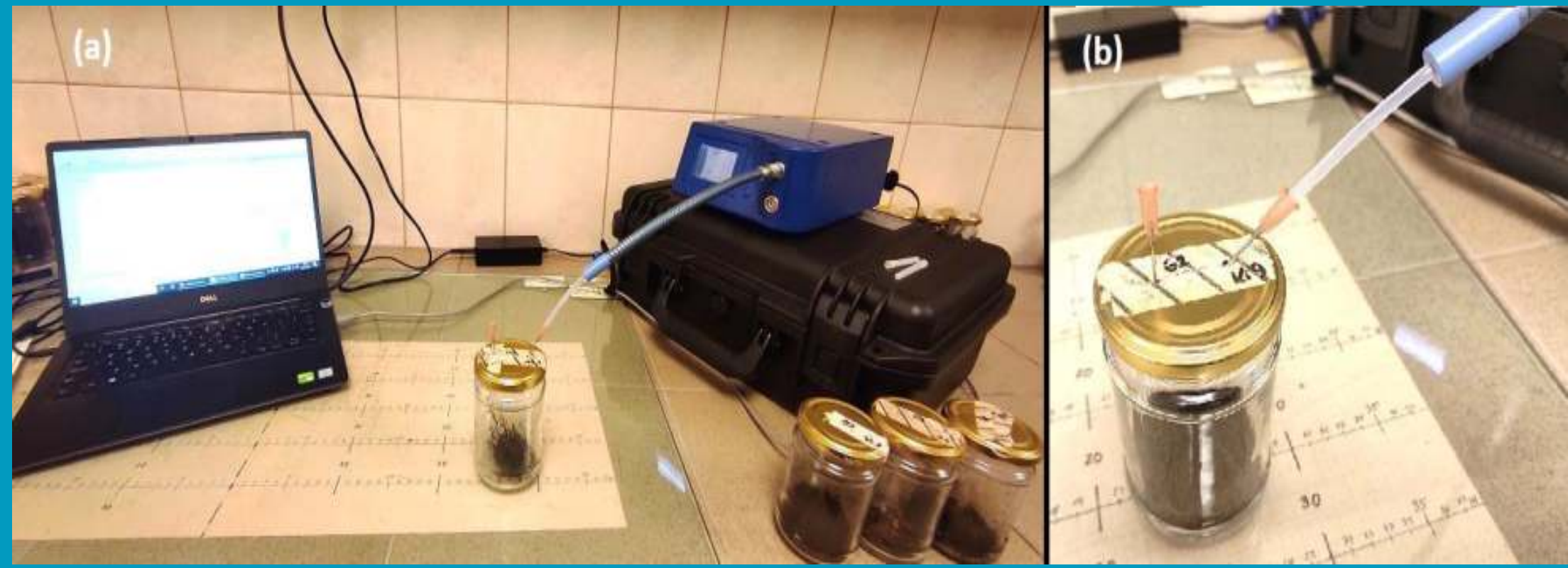
a) układ pomiarowy za pomocą e-nosa PEN3 b) stoik z próbką gleby podczas procedury pomiarowej
