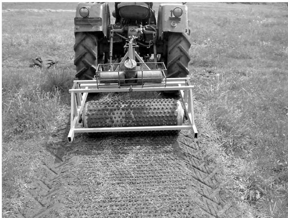
Ryc. 1. Wał symulujący intensywność użytkowania darni Fig. 1. Roller with mounted cleats to simulate wear on turf
