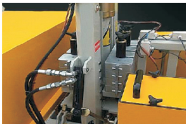
Fot. 2. Elementy mechaniczne układu odpowiedzialnego za generowanie obciążeń nawierzchni
