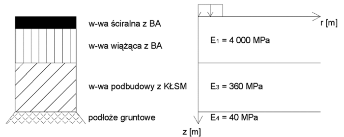
Rys. 8. Schemat przekroju konstrukcji nawierzchni jezdni i jego model obliczeniowy
